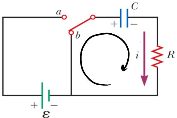
$$i(t) = -\frac{Q_0}{RC} e^{-\frac{t}{RC}} = -I_0 e^{-\frac{t}{RC}}$$
